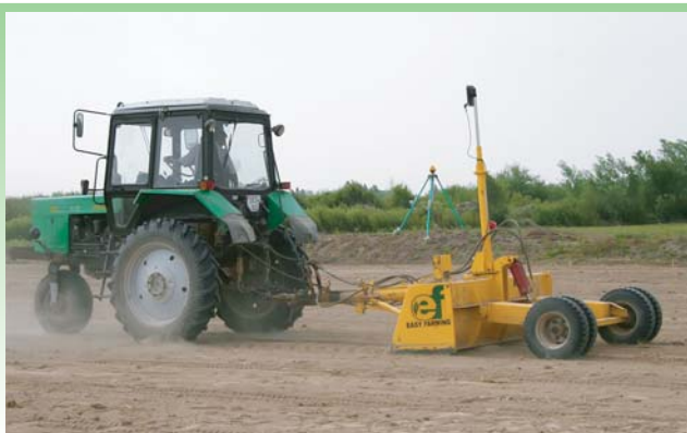
Обучение фермеров работе лазерного планировщика в Хорезмской области
